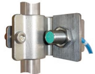
Funktionsweise: induktiv, Schaltelementfunktion PNP Schließer, Ausgangspolarität DC, Schaltabstand 2 mm, gesicherter Schaltabstand 0 - 1,62 mm, Einbau bündig, Nennspannung 10V - 60V, Schaltfrequenz 0 - 3000 Hz, Kurzschluss- und verpolgeschützt, Schutzart IP66/ IP67 gemäß EN 60529
