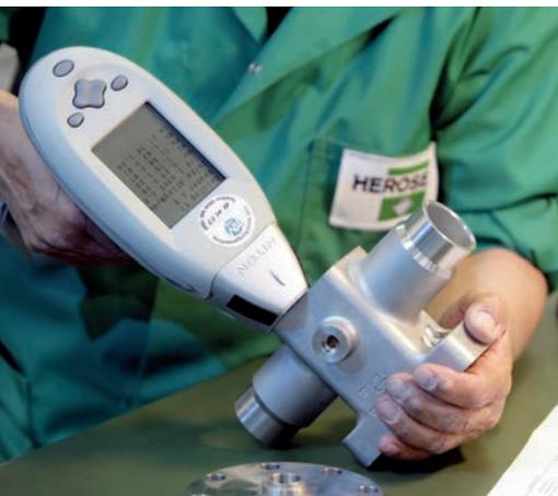
Materialanalyse und -identifikation während der Wareneingangsprüfung
